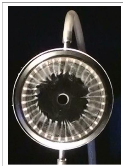
Rys.4 Zasysanie powietrza przez próbnik bez wiatru*
